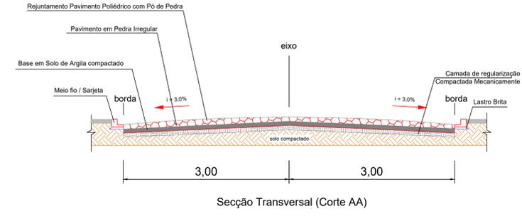
**Detalhe do Meio-Fio com Sarjeta (intransponível)**
