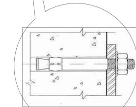
DETALHE FIXAÇÃO PARAFUSO TIPO PARABOLT
