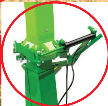
Comando hidráulico de giro de bica
